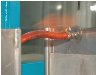
Techflex Silikon-ummanteltes Fiberglas wird extremen Dauertests ausgesetzt um einen zuverlässigen Brandschutz für Kraftstoff- und Hydraulikleitungen zu gewährleisten
