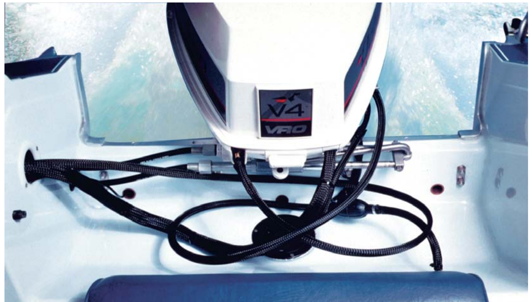
Heavy Wall schützt Anhänger-Anschlusskabel vor aufwirbelnden Gegenständen, UV-Schäden und Abrieb ohne die Flexibilität zu beeinflussen oder Feuchtigkeit zu speichern wie konventionelle Schlauchlösungen.
