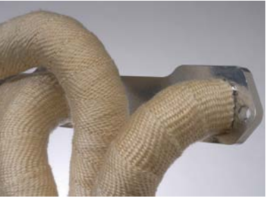
Bei der Auspuff-Isolierung eignet sich eine 6mm Überlappung ideal zur Leistungssteigerung, ohne den Auspuff zu beschädigen
