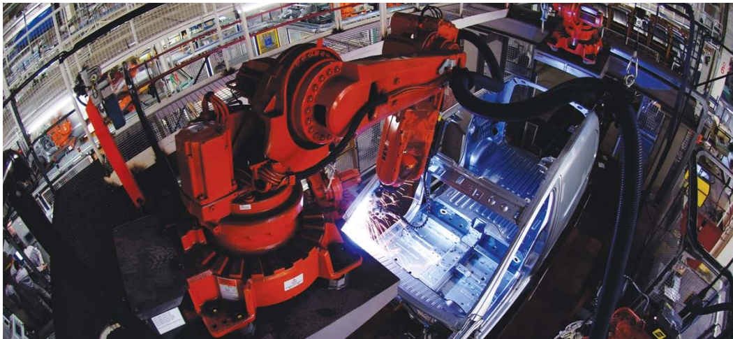
WeldWrap bündelt und schützt Leitungen an Schweißrobotern und statischen Schweißstationen.
