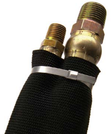
Hochdruckleitungen können gebündelt und so vor Abrieb und Wetter geschützt werden. Außerdem schützt die Ummantelung das Personal bei einem Hochdruckschlauchbruch.
